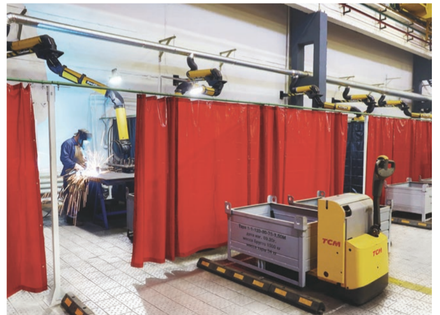
Защита от излучения и очистка воздуха в сварочно-заготовительном цехе
