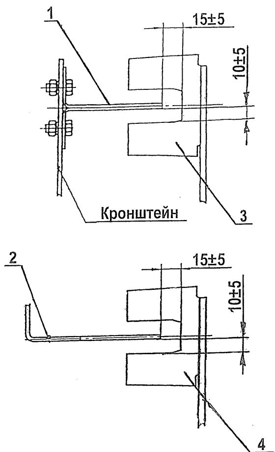
1 – шунт (на кабине); 2 – шунт (в шахте);
