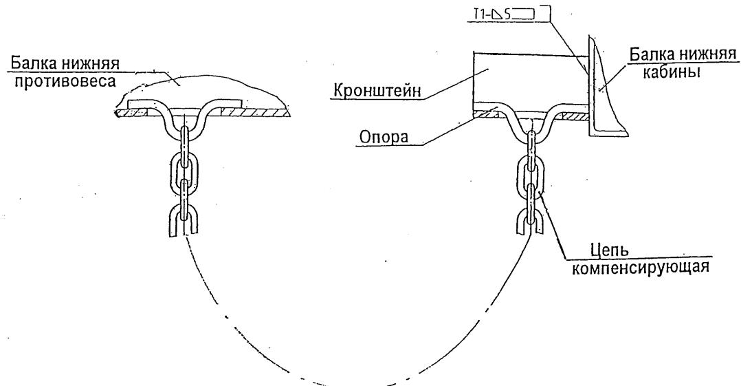
Рис. 11 – установка компенсирующей цепи
