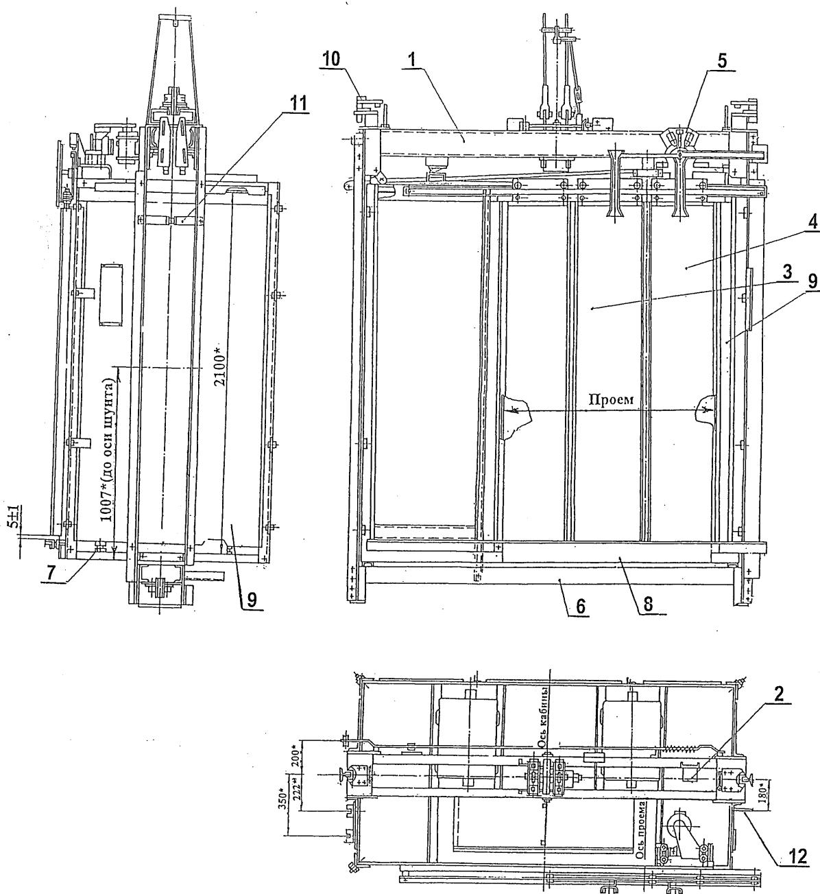
1 – верхняя балка; 2 – потолок; 3 и 4 – створки; 5 – балка с приводом ДК;
