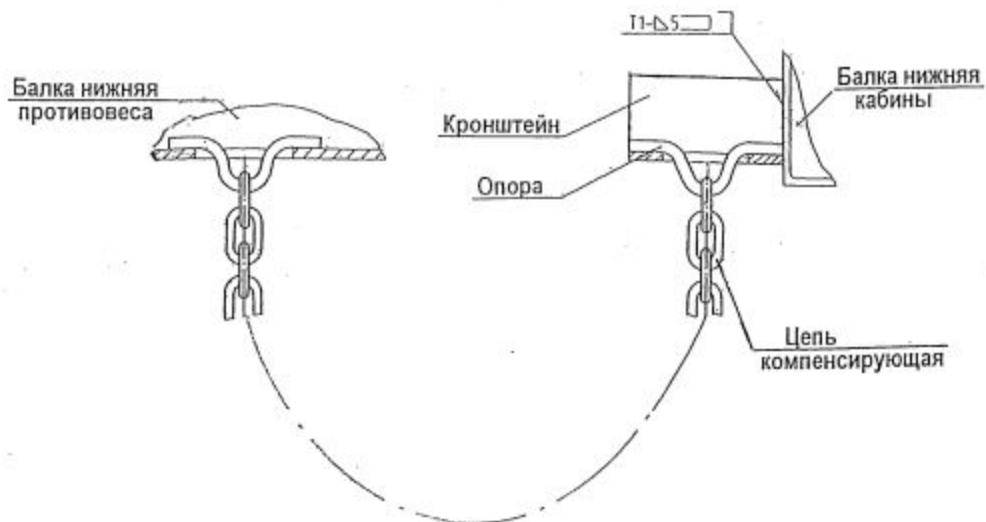
Рис. 11 – установка компенсирующей цепи
