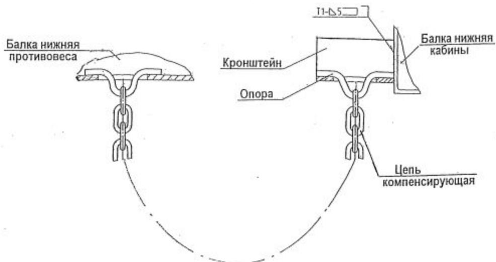
Рис. 11 – установка компенсирующей цепи
