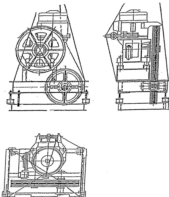
Рис.13.1 – схемы строповок лебедок OTIS
