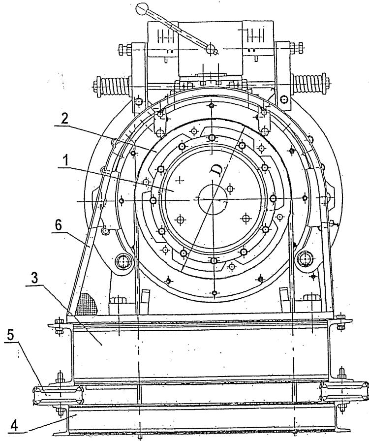
1 – двигатель; 2 – КВШ; 3 – рама; 4 – подрамник;
