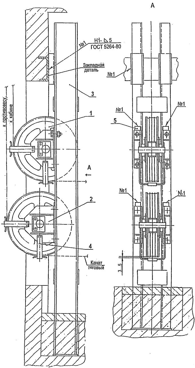
1 – блок сборе; 2 – блок в сборе; 3 – стойка; 4 – ограничитель; 5 – накладка
