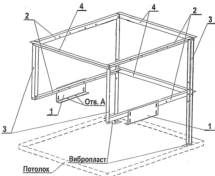
1 – кронштейн; 2 – поперечина боковая; 3 – стойка; 4 – поперечина задняя;
