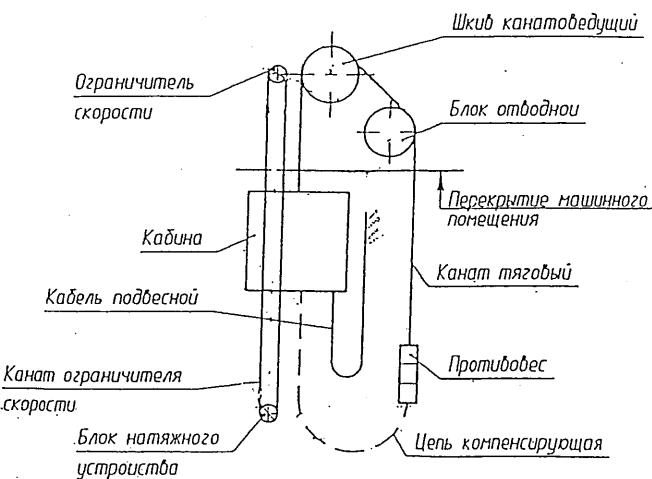
1 – лебедка; 2 – кабина; 3 и 4 – направляющие кабины и противовеса; 5 – канат ОС; 6 – канат тяговый; 7 – кабель подвесной; 8 – пост приказов (вызывной); 9 – ДШ; 10 – противовес; 11 – оборудование приемника; 12 – ВУ; 13 – НКУ; 14 – монорельс
