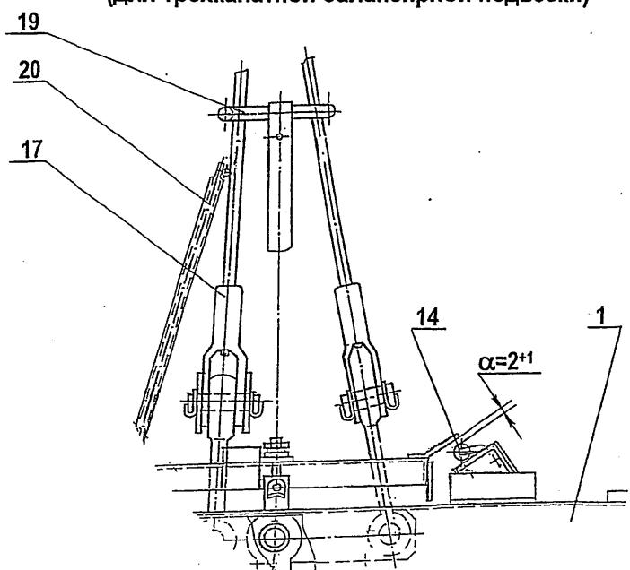
1 – балка; 2 – рычаг; 3 – рычаг клина; 4 – тяга; 5 – выключатель; 6 – упор; 7 – болт регулировочный; 8 – вал; 9 – колодка; 10 – клин; 11 – пружина; 12 – башмак тормозной; 13 – шпилька; 14 – выключатель; 15 – амортизатор; 16 – рамка; 17 – подвеска канатов; 18 – башмак скользящий; 19 – стяжка канатов; 20 – ДУСК; 21 – пружина; 22 – выключатель
