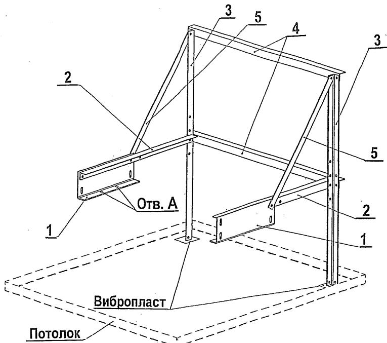
1 – кронштейн; 2 – поперечина боковая; 3 – стойка; 4 – поперечина задняя;
