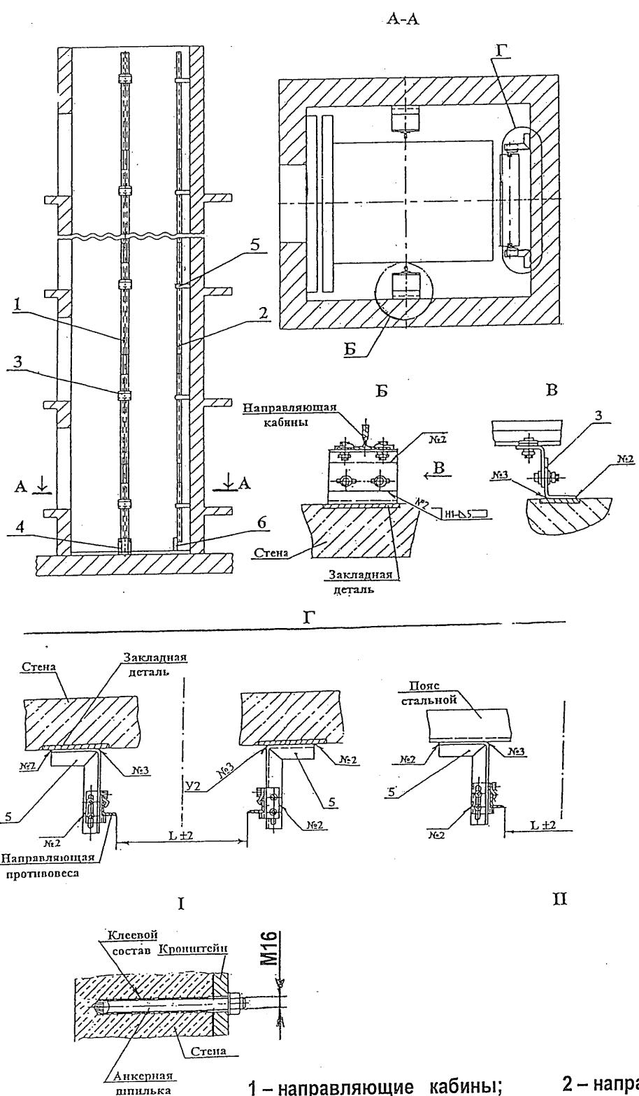
1 – направляющие кабины; 2 – направляющие противовеса; 3 – крепление направляющих кабины в приямке; 4 – крепление направляющих кабины в приямке; 5 – крепление направляющих противовеса; 6 – крепление направляющих противовеса в приямке
