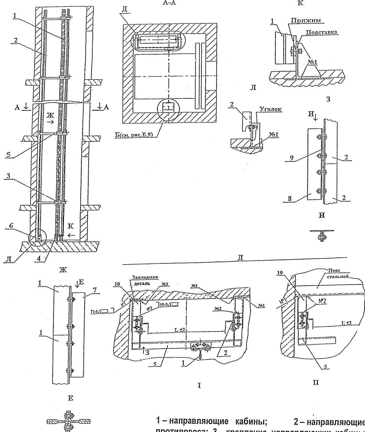
1 – направляющие кабины; 2 – направляющие противовеса; 3 – крепление направляющих кабины; 4 – крепление направляющих кабины в приямке; 5 – крепление направляющих противовеса; 6 – крепление направляющих противовеса в приямке; 7 – планка стыковая; 8 – уголок стыковой; 9 – прокладка
